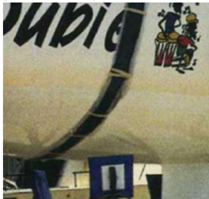
Nostoliinat kääntään muovin ja sivutukien/pukkiin päälle asetetaan kokolattiamatot pinnoitteen suojaamiseksi.
