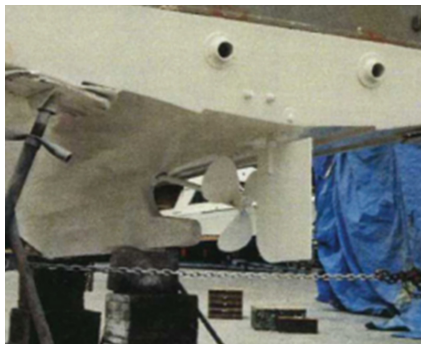
Sivutuet tulisi kiinnittää toisiinsa ketteingeillä, jotta ne eivät pääse liusumaan.
